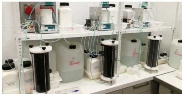
Figure: Columnas con geopolímero granulado.
